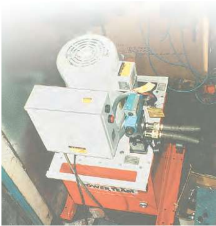
Eine PE4004S-Pumpe und ein RD3006-Zylinder beim Einsatz in einer Spezialpresse zur Reparatur defekter Kettenglieder in der Schiffbauindustrie.
