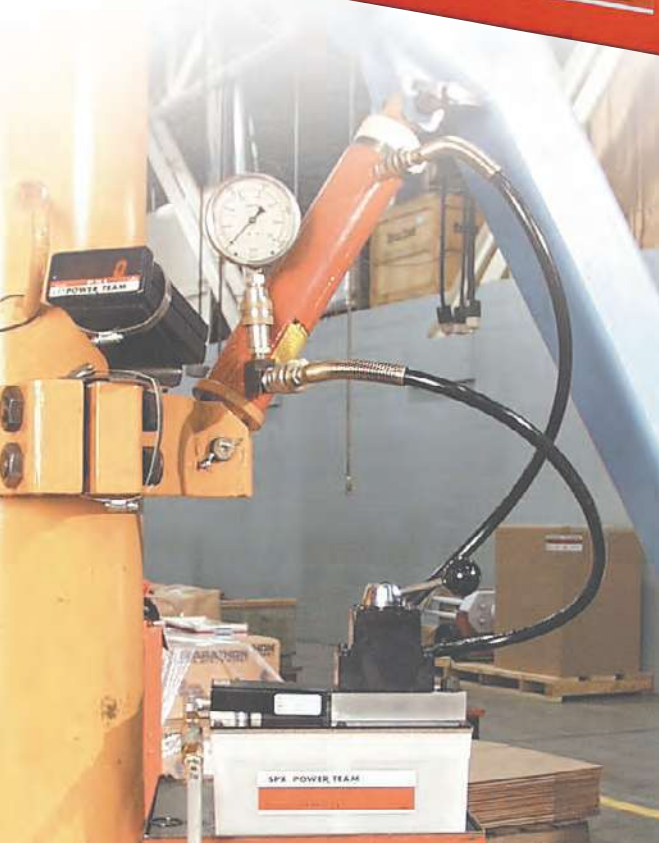
Die PA6D-Pumpe in einer Prüfvorrichtung mit einem digitalen Manometer DG100 und einem 25-Tonnen-Zylinder.
