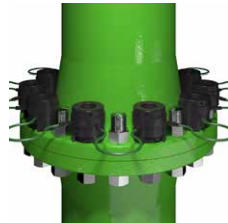
Set-up classico utilizzando una copertura di tensionamento del 50%. La metà dei tiranti viene messa in tensione contemporaneamente, quindi i tools vengono spostati sul secondo gruppo di tiranti.
