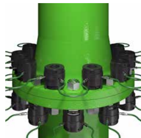
Set-up classico utilizzando una copertura di tensionamento del 100%. Tutti i tiranti vengono tensionati contemporaneamente. La particolare forma dei tubi di interconnessione utilizzati per collegare tutti i tensionatori dei bulloni nelle configurazioni di copertura al 100% ed al 50% è denominata "daisy chain".
