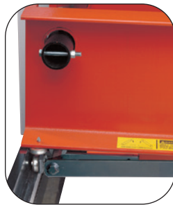
Rollenlager für die sanfte und problemlose Verstellung des Pressenbettes.
