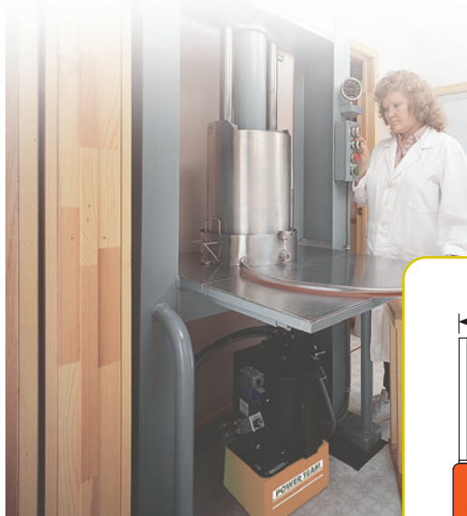
Einsatz einer Pumpe der PE21-Reihe mit einem RD5513-Zylinder in einer Spezialpresse zur Gewinnung von Extrakten für homöopathische Medikamente.
