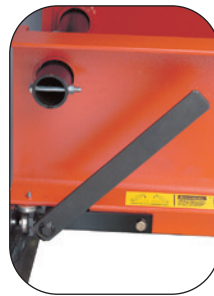
Hebel senkt das Pressenbett zum Pressen und hebt es zum Gleiten.
