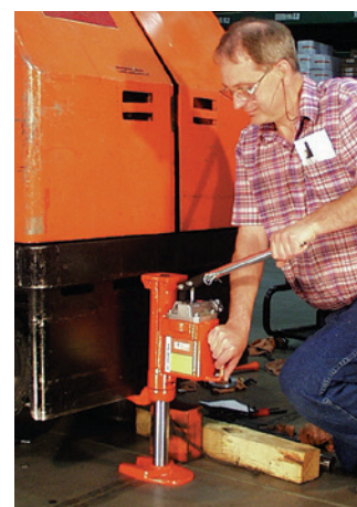
Ein Zungenheber der besonders robusten Reihe J bei Servicearbeiten an einem Hubwagen.
