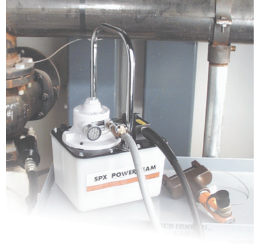
PA17-Pumpe im Einsatz mit einem Flanschspreizer.
